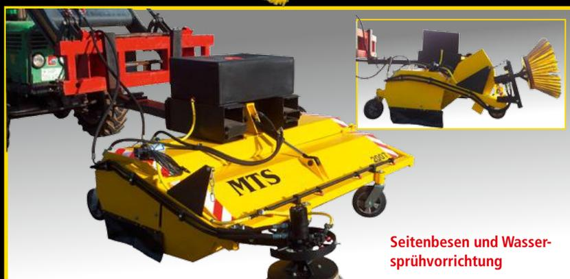
Seitenbesen und Wassersprühvorrichtung
