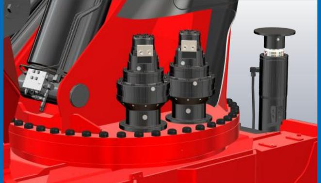
Das neue Schwenksystem mit 2 Drehmotoren gewährleistet einen gleichmäßigen und äußerst präzisen Betrieb. Die Motoren sitzen hinter einer praktischen Abdeckung, die sich bei Bedarf leicht abnehmen lässt.
